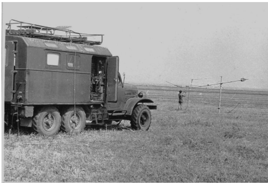
Рис. 14. Экспедиционная машина с регистрирующей аппаратурой и мачта-пантограф
