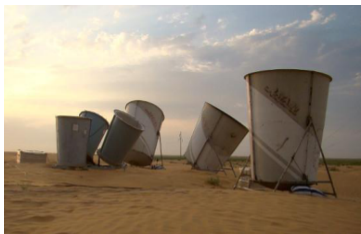
Рис. 2-3. Антенны содара и минисодара в шумозащитных экранах в процессе сборки в песках Калмыкии. 2016 г.
