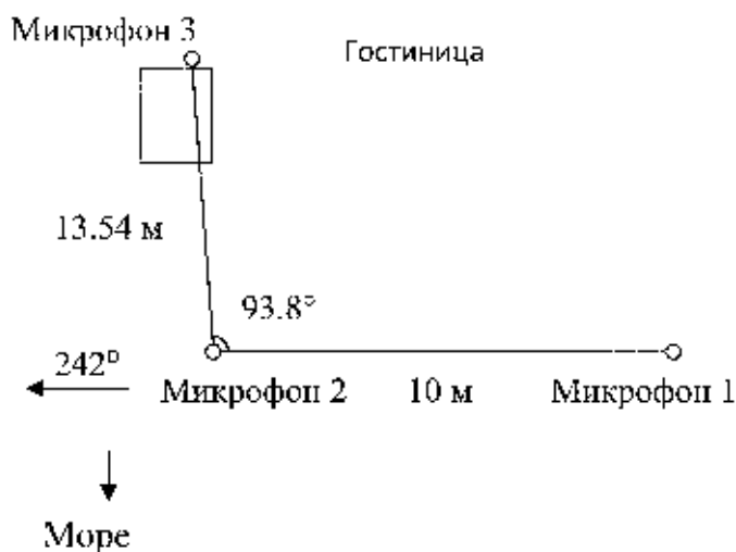
Рис. 1. Схема расположения приемных микрофонов вокруг здания гостиницы на территории филиала морского гидрофизического института в Качивели
