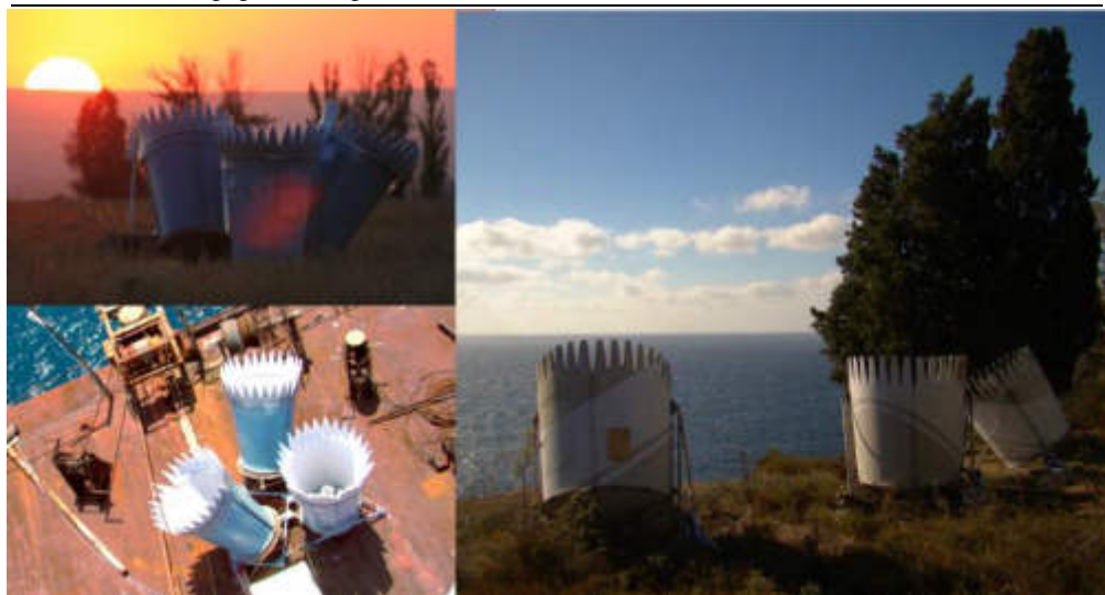
Рис. 2-6. Содарные измерения в экспедиционных условиях. Слева – мини содар в степи на ЦНС (вверху) и на океанологической платформе (внизу) летом 2015 г. Справа – содар на береговом склоне на Черноморском гидрофизическом полигоне, пос. Кацивели, осенью 2016 г.
